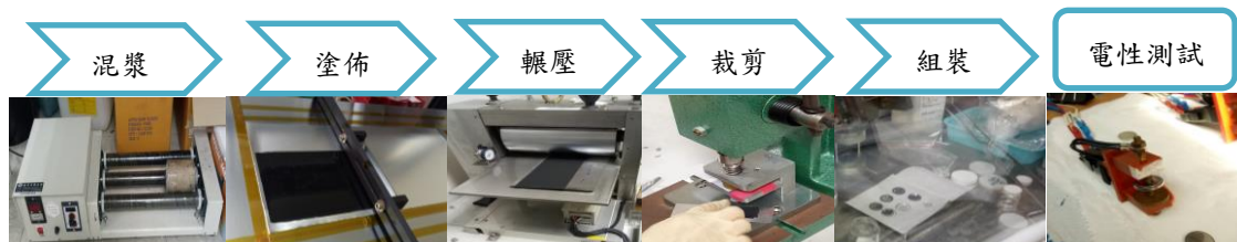
圖一 圖二 圖三 圖四 圖五 圖六 優異性:鈉離子電池具有與鋰離子電池類似的工作原理，且鈉資源豐富、成本低廉、性質相似，適合大規模儲能。
