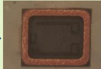
圖三、試片表面產生瘤狀物
