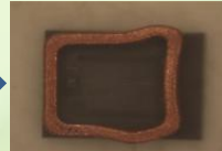
圖三、試片表面產生瘤狀物
