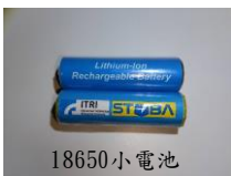
負極樣品搭配正極LiFePO 4 ，做成18650小電池之壽命測試
