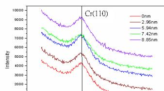
圖三不同下磁性層厚度之 XRD 結構分析
