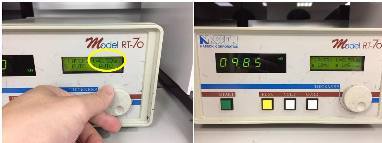
圖(五) 切換控制器模式及顯示量測結果
