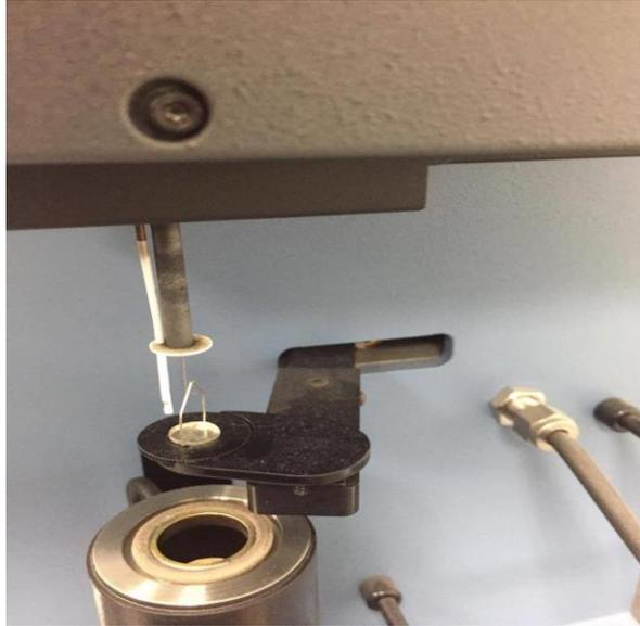
7. 歸零後，白金盤回到原位，放置 Sample 到白金盤上
