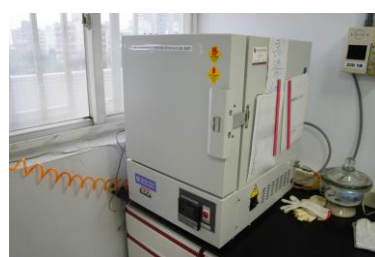
五. 高溫燒結爐
