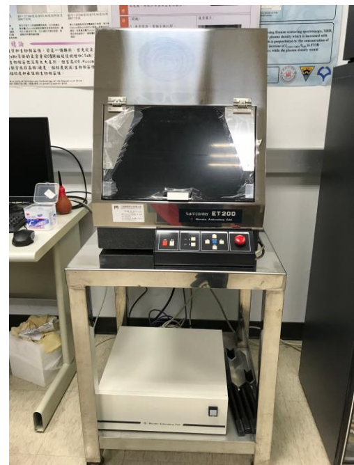
上方為輪廓儀機器，下方為機台電源與電腦主機。
