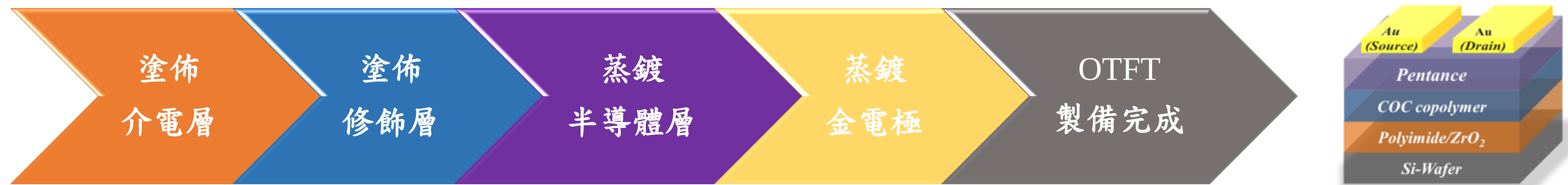
圖1、OTFT元件製作流程示意圖
